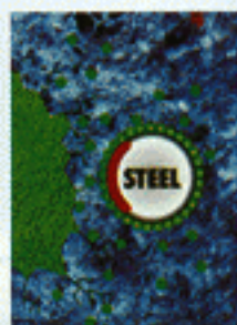
迁移防腐产品 迁移到钢筋表面 实现防腐
