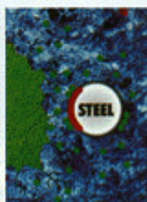
迁移防腐产品在 水泥中实现迁移
