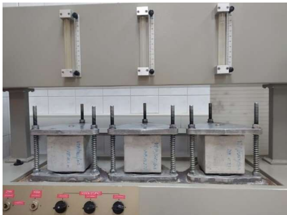
Slika 6 Uređaj za ispitivanje dubine prodiranja vode pod tlakom te granične vrijednosti najvećeg prodora vode za različite razrede vodonepropusnosti prema HRN 1128:2007
